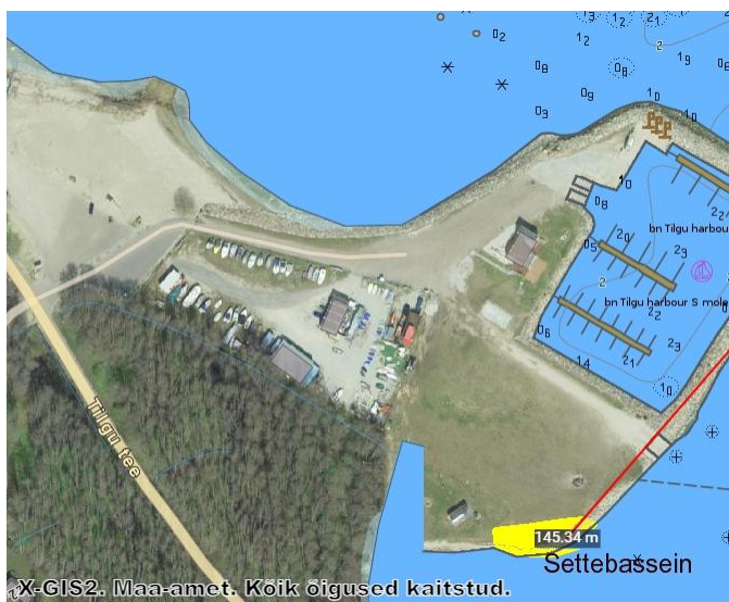
Joonis 2. Peale süvendamist paigutatakse pinnas settebasseini tahenema.
